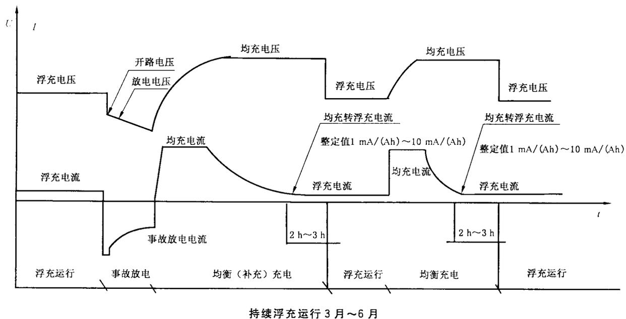
图 C.1 直流电源设备充放电特性示意图
