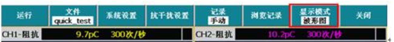
图 5-12 显示模式循环切换按钮
