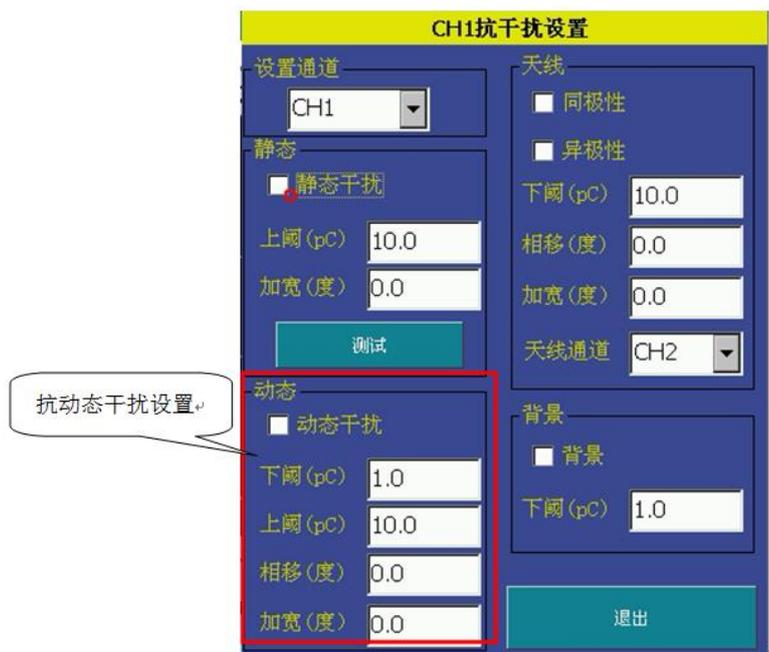
图 5-34 抑制动态干扰设置
