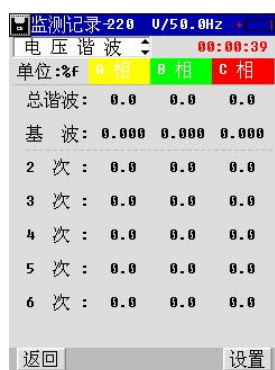
图 5-3 监测记录电压谐波
