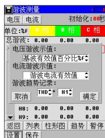
图 2-3 谐波测量设置
