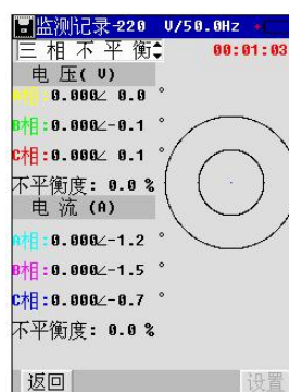
图 5-6 监测记录电压/电流不平衡
