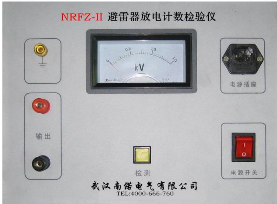
1. 将仪器输出端与避雷器计数器两端相连（连线要尽量短），红色端接上端，黑色端接地端。
