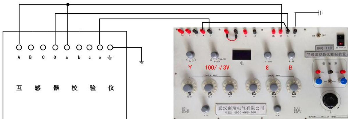
图7 检定二次压降仪相电压线路
