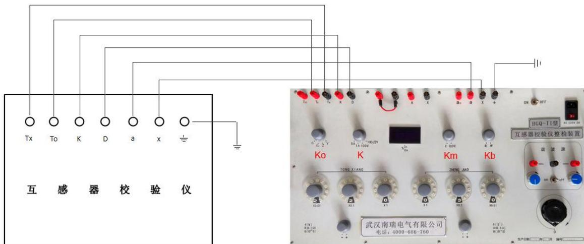
图1 检定互感器校验仪总线路
