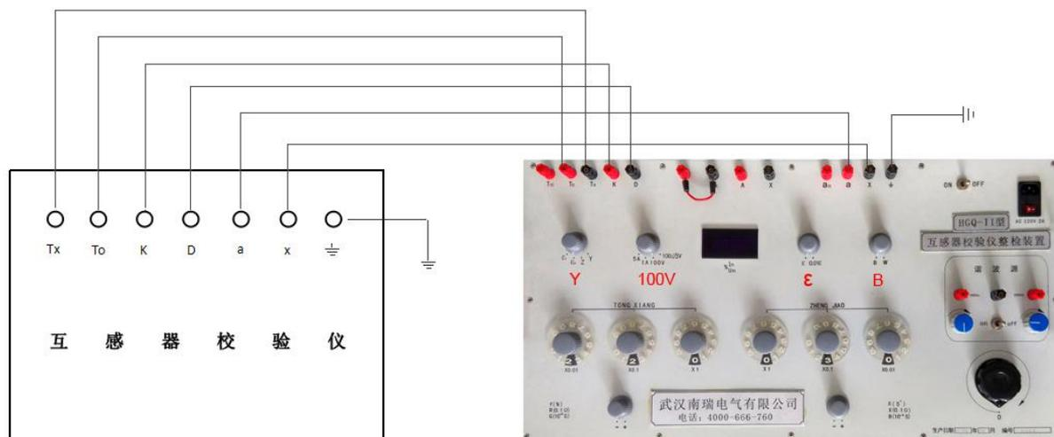
图5 检定校验仪测导线线路
