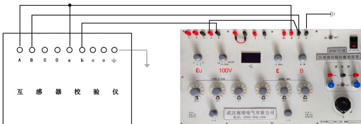
图6 检定二次压降仪线电压线路
