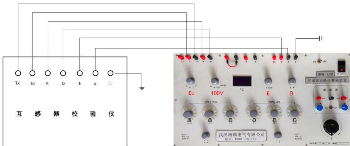
图3 检定校验仪测PT误差线路
