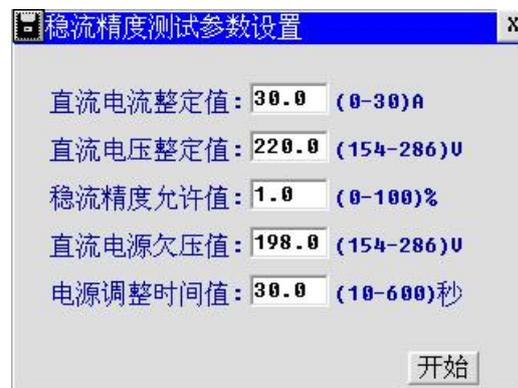
图 4-3-2 稳流精度测量参数设置
