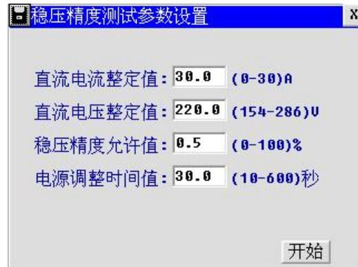
图 4-2-2 稳压精度测量参数设置
