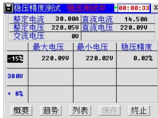
图 4-2-4 稳压精度测量列表显示
