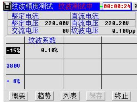
图 4-4-3 纹波系数测量概要显示
