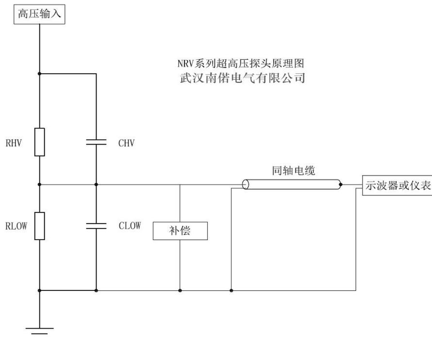
(II) 分压网络由RC并联的高压网络组成，低压网络由并联RC网络和补偿电路组成。低压网络 放置在一个全屏蔽的金属矩形盒子里面，用于代替二次回路的低压部分，NRV系列探头可以 配备多个分压盒，每个不同的分压比都会被校验。这些探头可根据客户的要求定做分压比， 取代示波器中添加的补偿电容。
