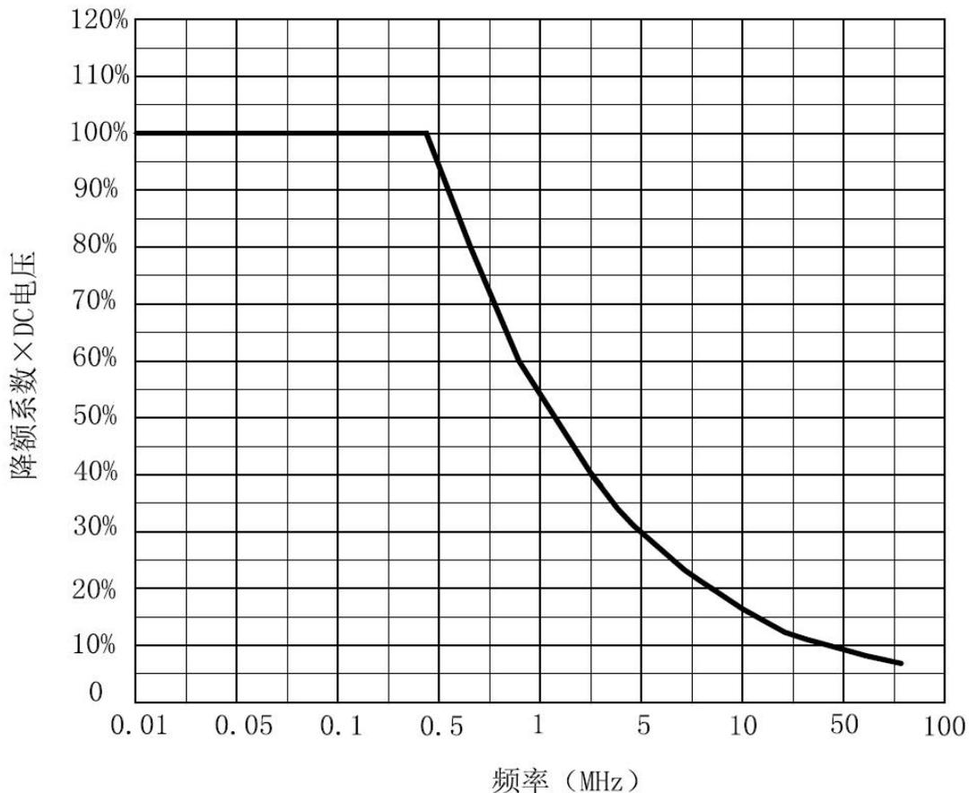
**说明：** 计算公式为  $100\text{kV} (\text{额定值}) \times \text{降额系数} = \text{实际能测量电压值 (kV)}$
