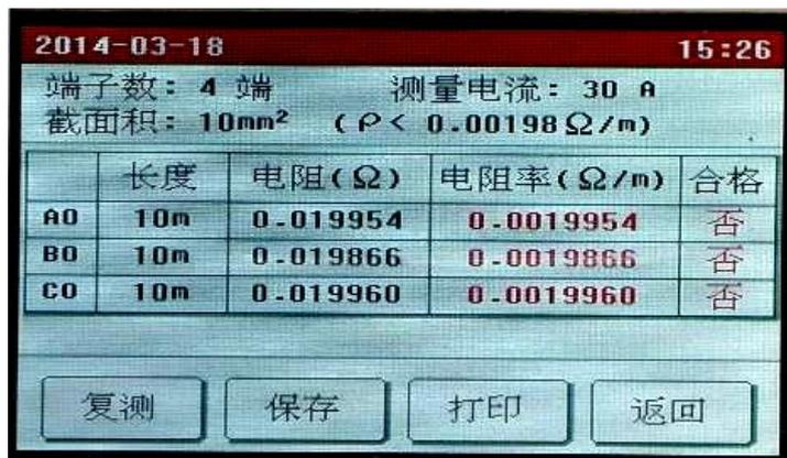
测试完成后如需重新测量一次可按“复测”键仪器可重复测量一次。
