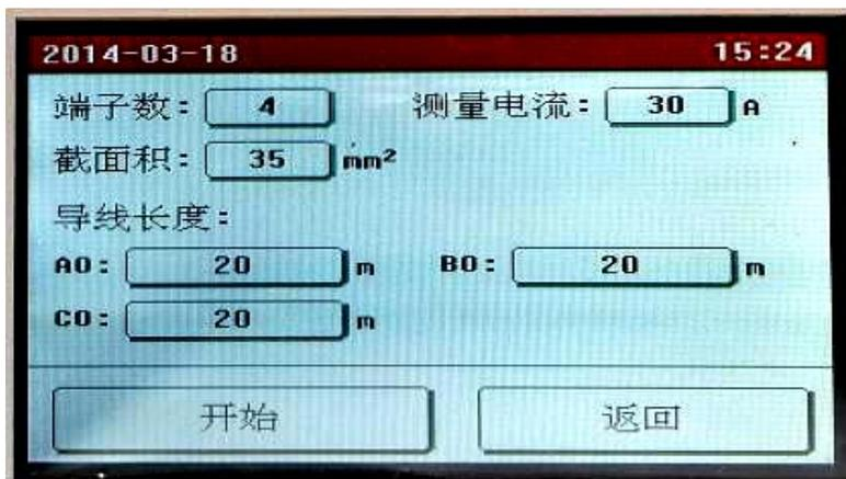
点击需要修改的参数设置框设置参数，全部设置完成后点击“开始”按钮，仪器即按照设置的参数开始自动测量各端子的电阻值，并计算电阻率，自动判断接地线是否合格。
