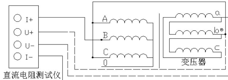
图 7.4 测量低压 Rcb 的接线方法
