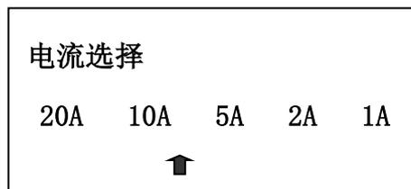
7.3 测试：当选择好电流后，按下确认键，就开始测试，表头同时指示
