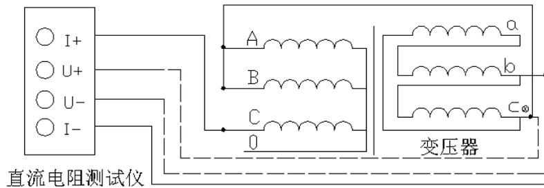
图 7.3 测量低压 Rba 的接线方法
