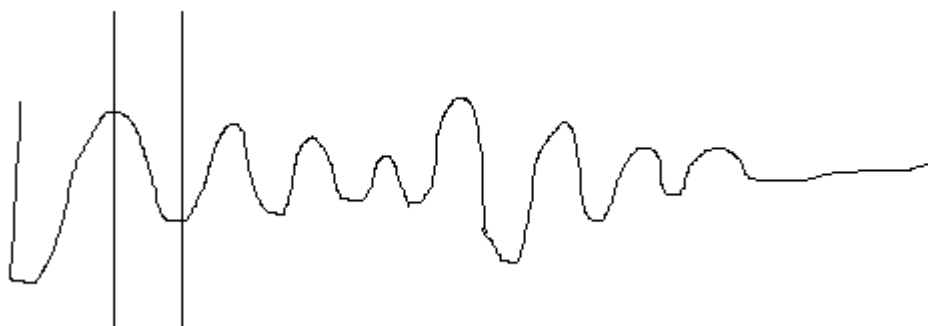
电缆类型：塑料电缆 故障距离：26 米
