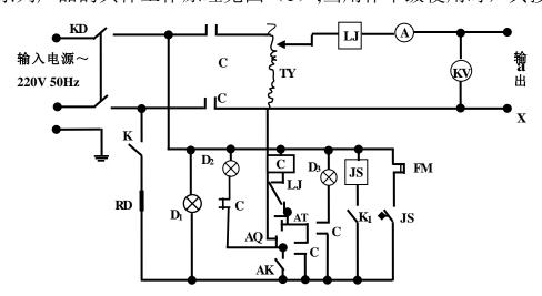
GTB: 试验变压器 JS: 时间继电器 TY: 自藕调压器 FM: 报警器
