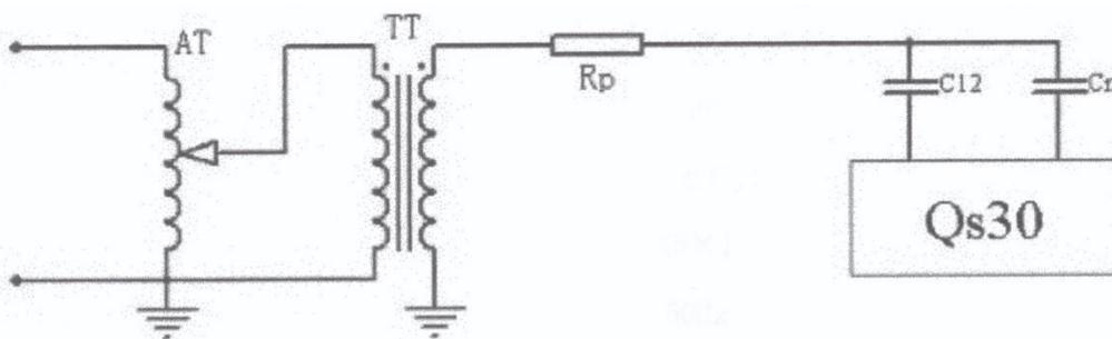
TT: 工频试验变压器 (也可用谐振电源)
