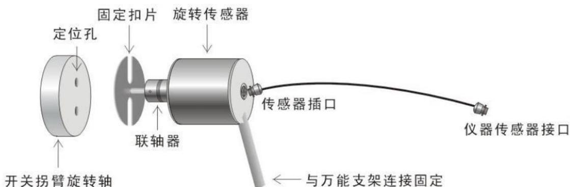
安装注意: 旋转传感器的轴应尽量与开关旋转轴保持同心, 否则传感器旋转有阻碍, 测出曲线的毛刺会很重, 影响测试数据的准确。
