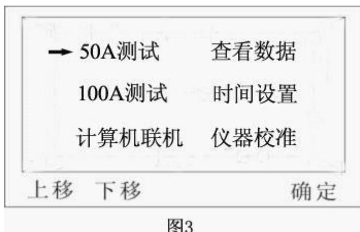
系统主菜单设置了五组功能模块，分别是“50A 测试”“100A 测试”“查看数据”“时间设置”“仪器校准”。以下分别介绍。
