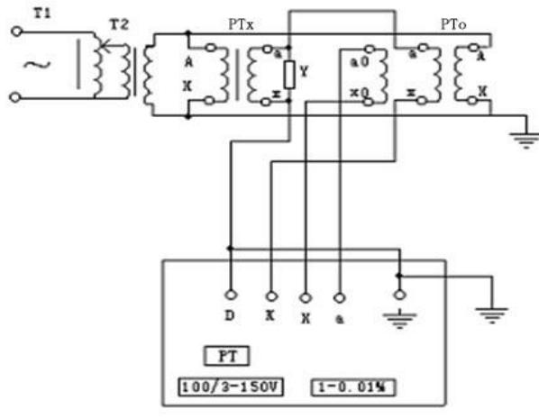
2. 电压互感器校验接线图
