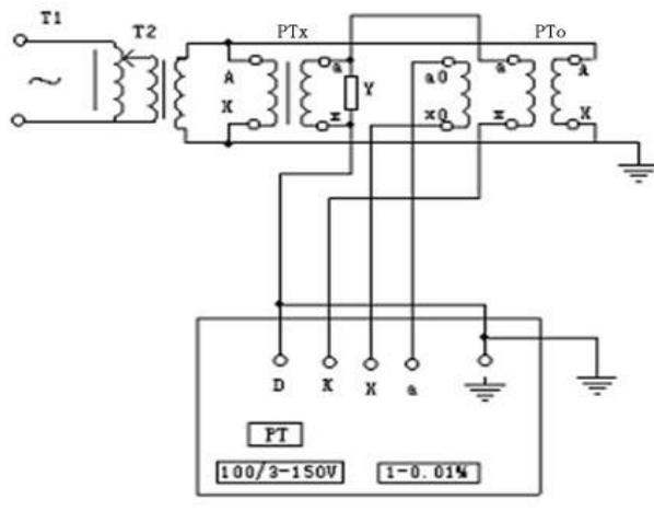
2. 电压互感器校验接线图
