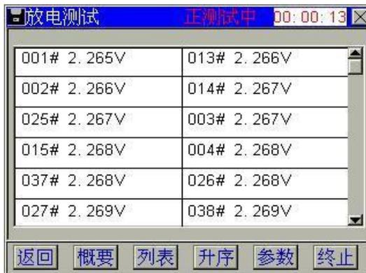
图 4-5-9 电池放电升序显示
