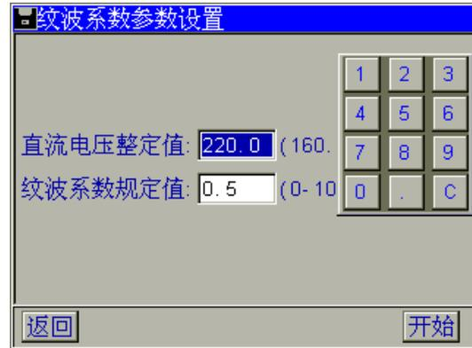
图 4-4-2 纹波系数测量参数设置
