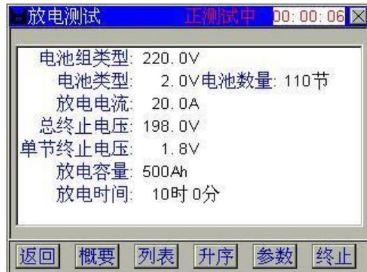
图 4-5-10 电池放电设置参数
