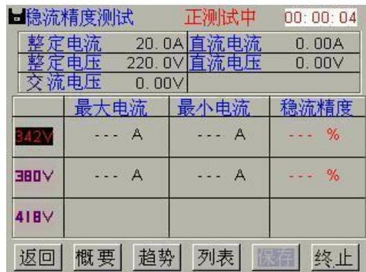
图 4-3-4 稳流精度测量列表显示
