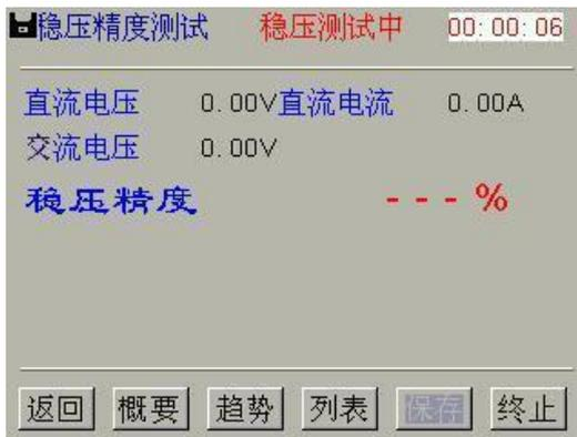
图 4-2-3 稳压精度测量概要显示
