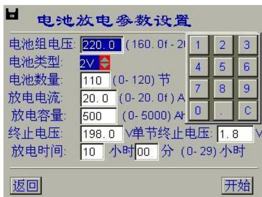
图 4-5-2 电池放电参数设置
