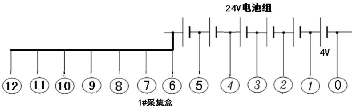
如果电池数超过每个采集盒能采集的相应电池数，则需要使用多个数据采集盒。则需要多个采集盒，下图是多个 12V 电池的连接方式，2V、4V、6V 电池连接同理：
