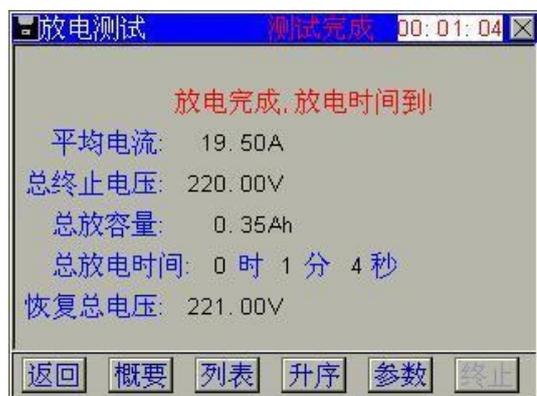
图 4-5-12 电池放电测试完成
