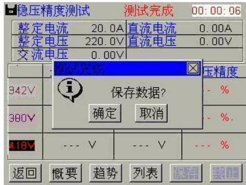
图 4-2-7 稳压精度测量保存提示
