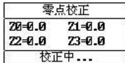
在设备无法正确采集到放电电压，电流时，可进行零点校正。**(一般建议不要使用。)**
