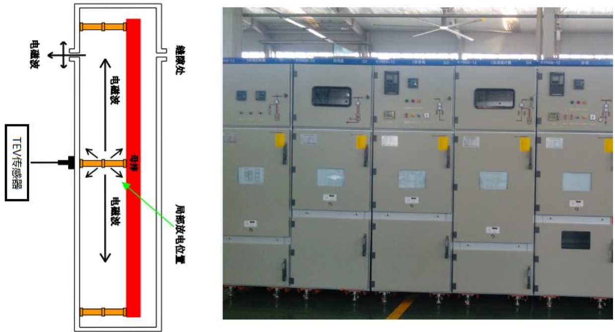
图 5-1 TEV 检测原理
