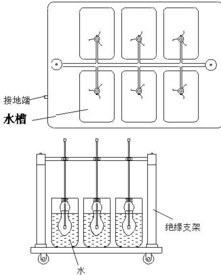
图 3-2 绝缘靴（手套）试验台
