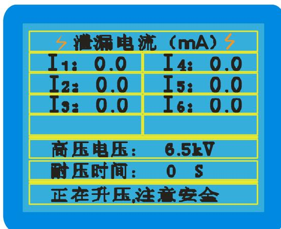
当某一路的泄漏电流达到所设定的过流值并超过时, 此时会反白显示, 并且过流保护停止升压调压器自动归零, 出现以下界面:
