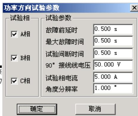
一些试验人员对保护最大灵敏角的正、负难以区分，所以软件对这里最大灵敏角的整定值输入采用了模糊技术，假设保护的最大灵敏角是 $-45^\circ$ ，无论试验人员输入 $-45^\circ$ 还是 $+45^\circ$ ，都不会影响正常的试验。参数设置对话框如右图所示。
