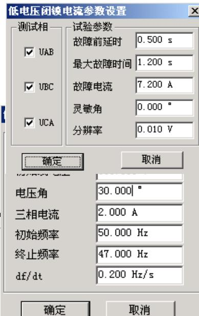
该项目是测试低频（高频）保护的动作频率和动作时间。参数设置界面如右图所示：
