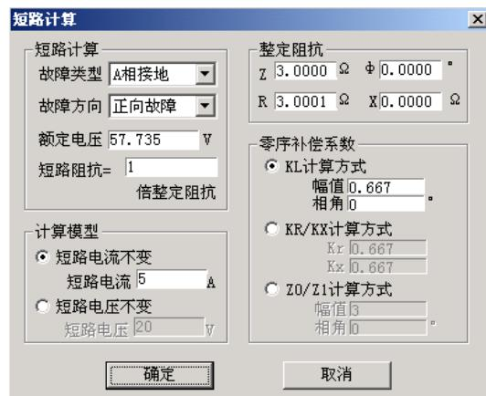
因为后加速故障是在重合于故障态才引起的，所以必须是在重合态后立即进入永跳状态，后加速保护才能正确动作。如果“最长状态时间”期间输出的是故障量，当测试仪接收到保护的动作信号时，而试验前同时又选择了“开入量触发”作为状态的翻转条件的话，测试仪将跳过所设置的余下的“最长状态时间”进入“触发后延时”状态。
