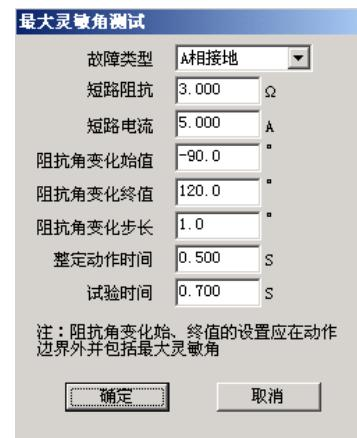
个合适的变化步长就可以测出精度符合要求的最大灵敏角。
