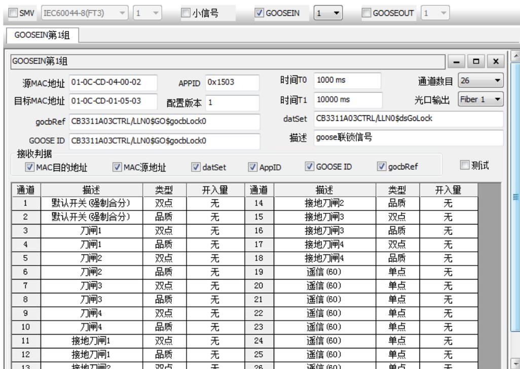
图 2.4.1.3-4 GOOSE IN 配置界面总览
