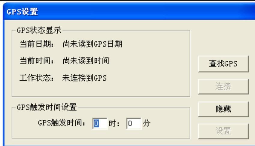
⑤ 按下“查找GPS”按钮，此时软件开始查找是否有GPS触发器存在，当找到后，则弹出对话框显示：“有GPS触发器”的提示，此时可以进入下一步操作。否则会显示“没有找到GPS触发器”，并在“工作状态”中显示“未连接到GPS”。出现这种情况可能有以下原因造成：
