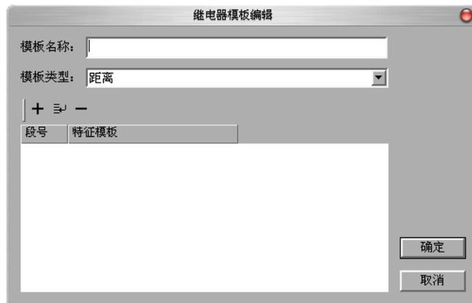
④ 输入模板名称，选择模板类型，模板类型分为距离、反时限、电源变压器和其他四类，根据需求选择相应的模板类型，选择好后其下方将显示相应的编辑视图。
