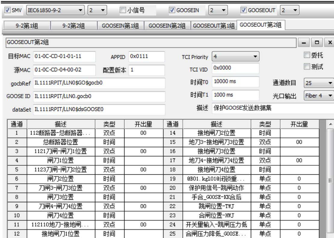
图 2.13.2-8 SCL 解析 GOOSE 导入 GOOSEOUT 配置界面
