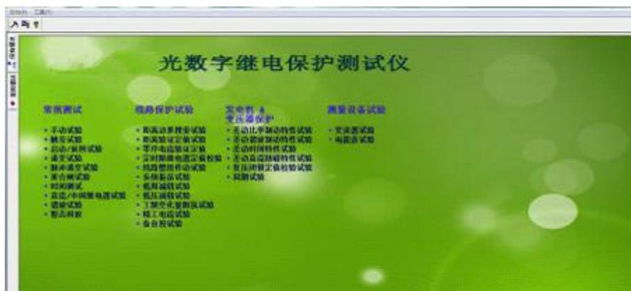
在主界面的最上方是菜单栏，可以从中选择所需要的操作；在菜单栏的下方是工具栏，有三个快捷按钮，分别为：系统设置、重新联机和关于；界面中间是试验模块快捷方式列表，共分为四大类，分别是：常规测试、线路保护测试和发电机/变压器保护测试。
