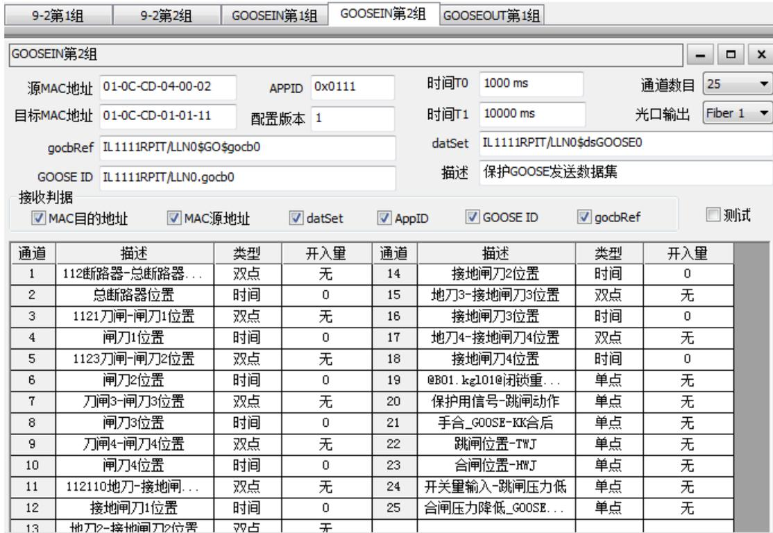
图 2.13.2-6 SCL 解析 GOOSE 导入 GOOSEIN 配置界面
