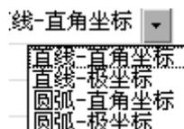
曲线类型分直线和圆弧两种，每种类型有直角坐标和极坐标两种表示方式。
