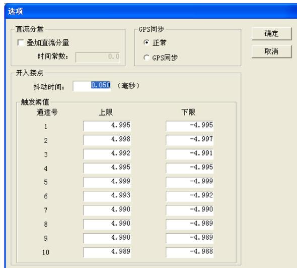
③ 在试验设置部分设置好试验参数，并按开始按钮，此时程序处于等待 GPS 触发信号的状态。
